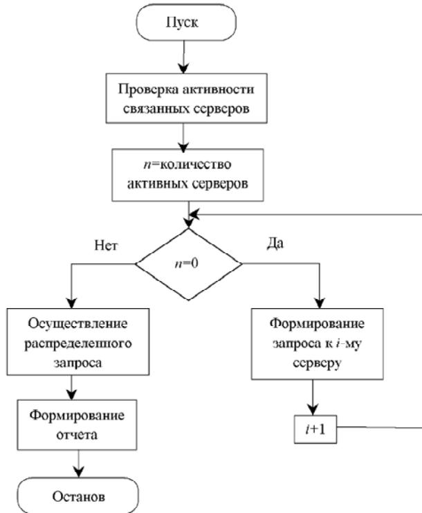
Рисунок 5 – Схема формирования распределенного запроса
