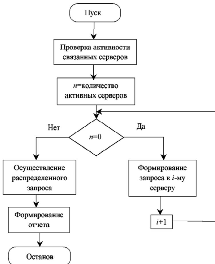
Рисунок 6 – Схема обработки распределенного запроса
