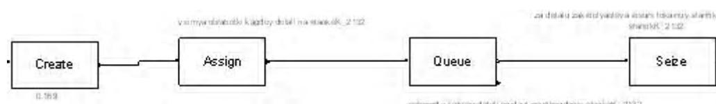
**Рис. 2.** Использование блоков ‘CREATE’, ‘ASSIGN’, ‘QUEUE’ и ‘SEIZE’ в модели производства автомобильных клапанов в системе имитационного моделирования Arena
