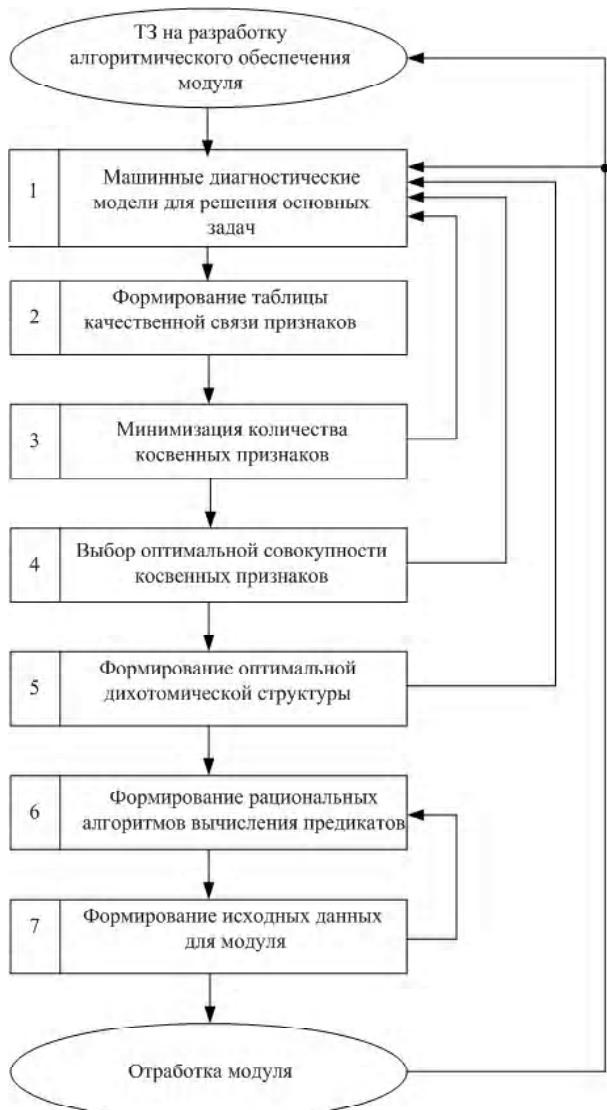
Рис. 5. Схема разработки алгоритмического обеспечения модуля ДФС
