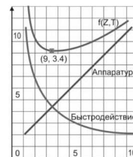
Рис. 4. Функции аппаратуры и времени от числа разбиений
