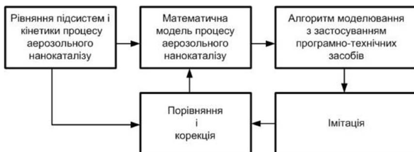
Рис. 6. Структура схеми математичного моделювання
