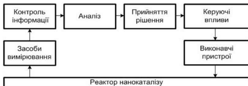
Рис. 5. Загальна схема системи керування процесом аерозольного нанокatalізу
