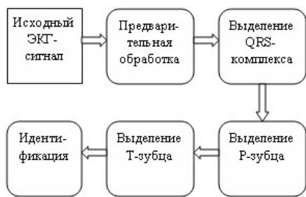
Рис. 3. Структура обробки ЕКГ-сигналу
