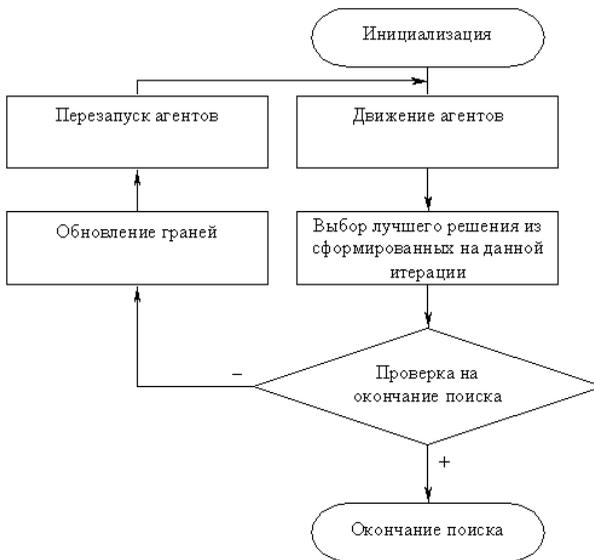
Рисунок 2 – Обобщённая схема работы метода муравьиных колоний
