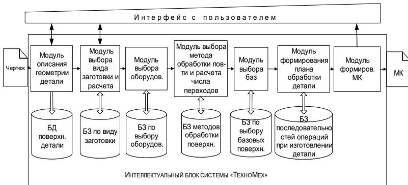
Рисунок 1 – Схема системы «ТехноМех»
